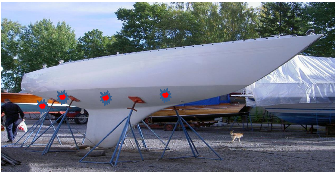
Figur 1. Mätpunkter på båtar mätta av Happy Boat AB. Mätningar utfördes 10-30 cm nedanför vattenlinjen på både styrbord och babord sida enligt bilden (styrbord bak, styrbord mitt, styrbord för, babord för, babord mitt och babord bak plus ömse sidor av rodret). På motorbåtar utan roder mättes på akterspegeln eller drevstocken.
